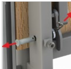
Αφαίρεση πείρου διχαλωτής σύνδεσης, αποστάτη και άγκιστρου τύπου 'R'
