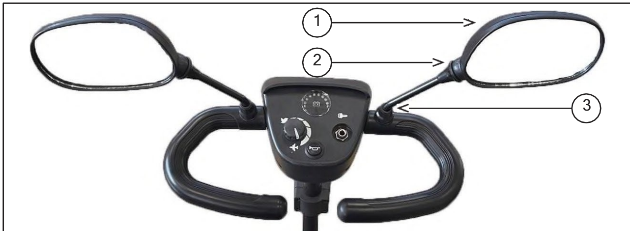
Εικόνα 3. Τιμόνι με χειρολαβές τύπου D και καθρέπτες
