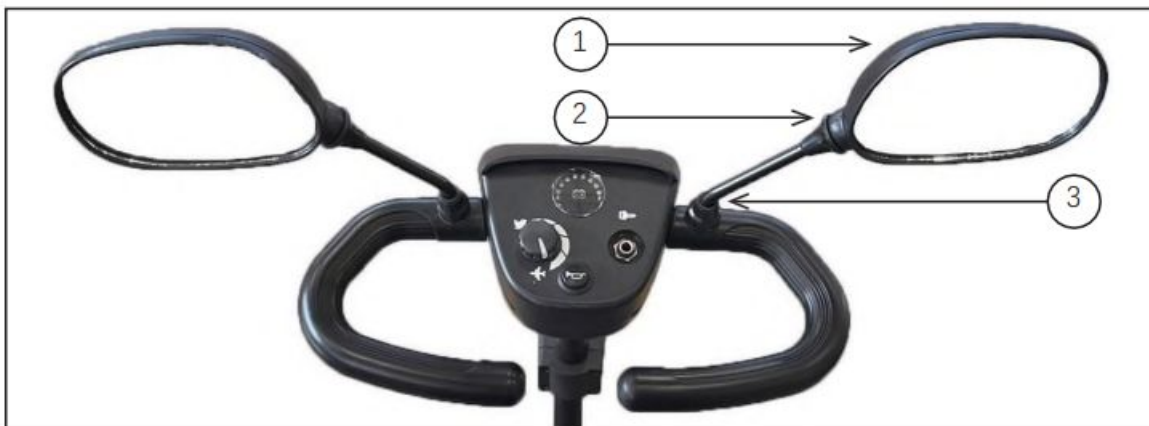
Obrázok 3. Riadiaca jednotka a spätné zrkadlá
